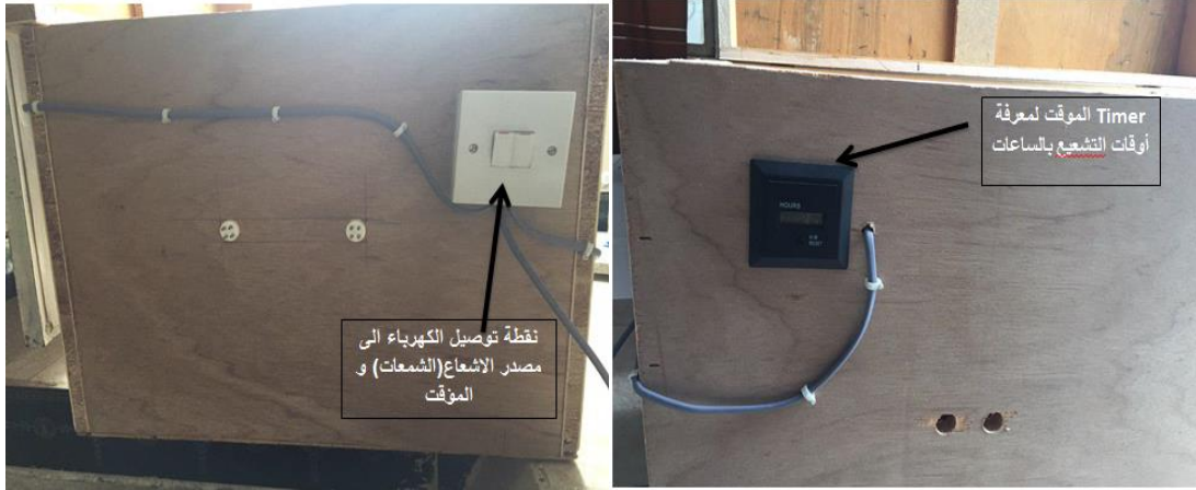
الشكل (2-3) تصميم منظومة التشعيع محلية الصنع
